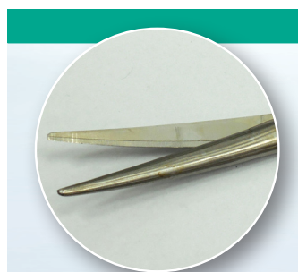
Fjernelse af alle tegn på slid og afrunding af alle skarpe kanter
