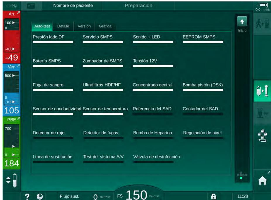
Fig. 5-3 Estado de la secuencia de auto-test en la pantalla *Servicio*
