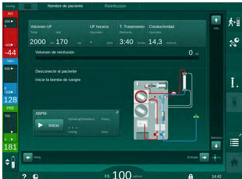
Fig. 6-19 Pantalla de reinfusión - preparación de la reinfusión
