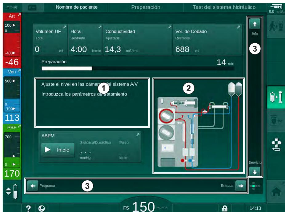
**Fig. 3-12** Áreas de instrucción y barras de desplazamiento en la pantalla *Inicio* durante la preparación
