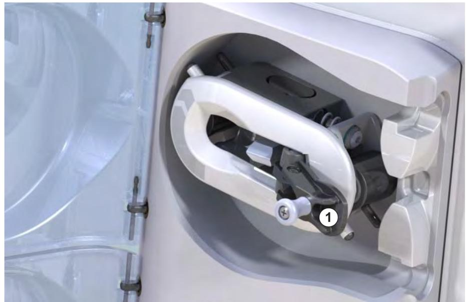
Fig. 12-4 Manivela integrada para el retorno manual de sangre
