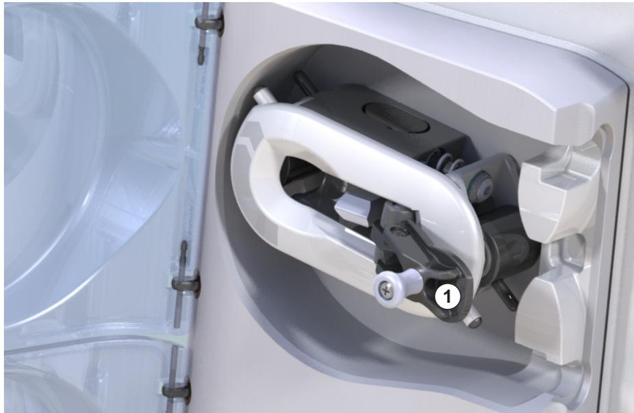
**Fig. 12-8** Manivelle intégrée pour la restitution manuelle du sang
